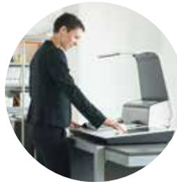
**#75 zeta Office von Zeuschel:** Der Overhead-Scanner übernimmt die Digitalisierung von Papierdokumenten. Da der Scan von oben erfolgt, kann der Ordner oder das gebundene Dokument einfach aufgeschlagen und für den nächsten Scan bequem umgeblättert werden – ohne mühsames Herausnehmen der Schriftstücke.
