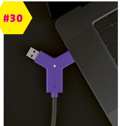
**SWYTCH VON LOGITECH:** An dieser Bring-Your-Own-Meeting-Lösung hat uns besonders gut gefallen, dass nur der USB-Adapter (Typ-A und Typ-C) sichtbar ist. Um an einer Videokonferenz teilzunehmen, muss das Notebook nur mit diesem Adapter verbunden werden. Die weiteren Bestandteile von Swytech (Extender und Hub) werden in den Konferenzraum integriert.
