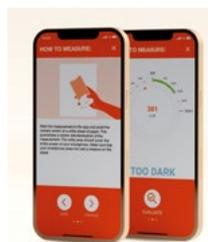
**LUX-O-METER-APP VON LEDVANCE:** Im Büro ist eine Beleuchtungsstärke von mindestens 500 Lux vorgeschrieben, zu Hause werden allerdings oft nur 100–200 Lux erreicht. Ob der Lux-Wert im Homeoffice ausreichend ist, lässt sich mit dieser für iOS- und Androidgeräte geeigneten App prüfen.
