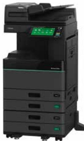
**e-STUDIO5008LP von Toshiba:** Die Eco-Hybrid-Multifunktionsgeräte von Toshiba kombinieren herkömmliches Drucken mit der Möglichkeit, Papier mehrfach zu verwenden. Das gelingt mit einem speziellen blauen Toner. Dieser kann durch eine integrierte Wiederaufbereitungsfunktion durch eine thermische Behandlung neutralisiert werden. Wichtiges kann mit einem unlöschbaren schwarzen Toner gedruckt werden.
