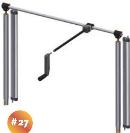
**Ket-Twist 660-3053 von Ketterer:** Dieses neue Kurbel-Hubsystem ist eine „grüne“ Lösung für höhenverstellbare Arbeitsplätze. Ganz ohne Strom, quasi im Handumdrehen, ermöglicht es die stufenlose Einstellung der Arbeitshöhe von 590 bis 1.250 mm. Pro Kurbeldrehung werden 40 mm Höhenunterschied realisiert. Das bringt gleich doppelt Bewegung ins Büro!
