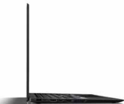
**#53 ThinkPadX1 Carbon von Lenovo:** Nur 1,14 kg schwer und schlanke 15,95 mm dick ist dieses Notebook mit 14-Zoll-Display. Der Akku hält 15,5 Stunden und lässt sich dank RapidCharge-Technik in nur 60 Minuten auf 80 Prozent aufladen. Das kohlefaserverstärkte Gehäuse ist sehr robust.
