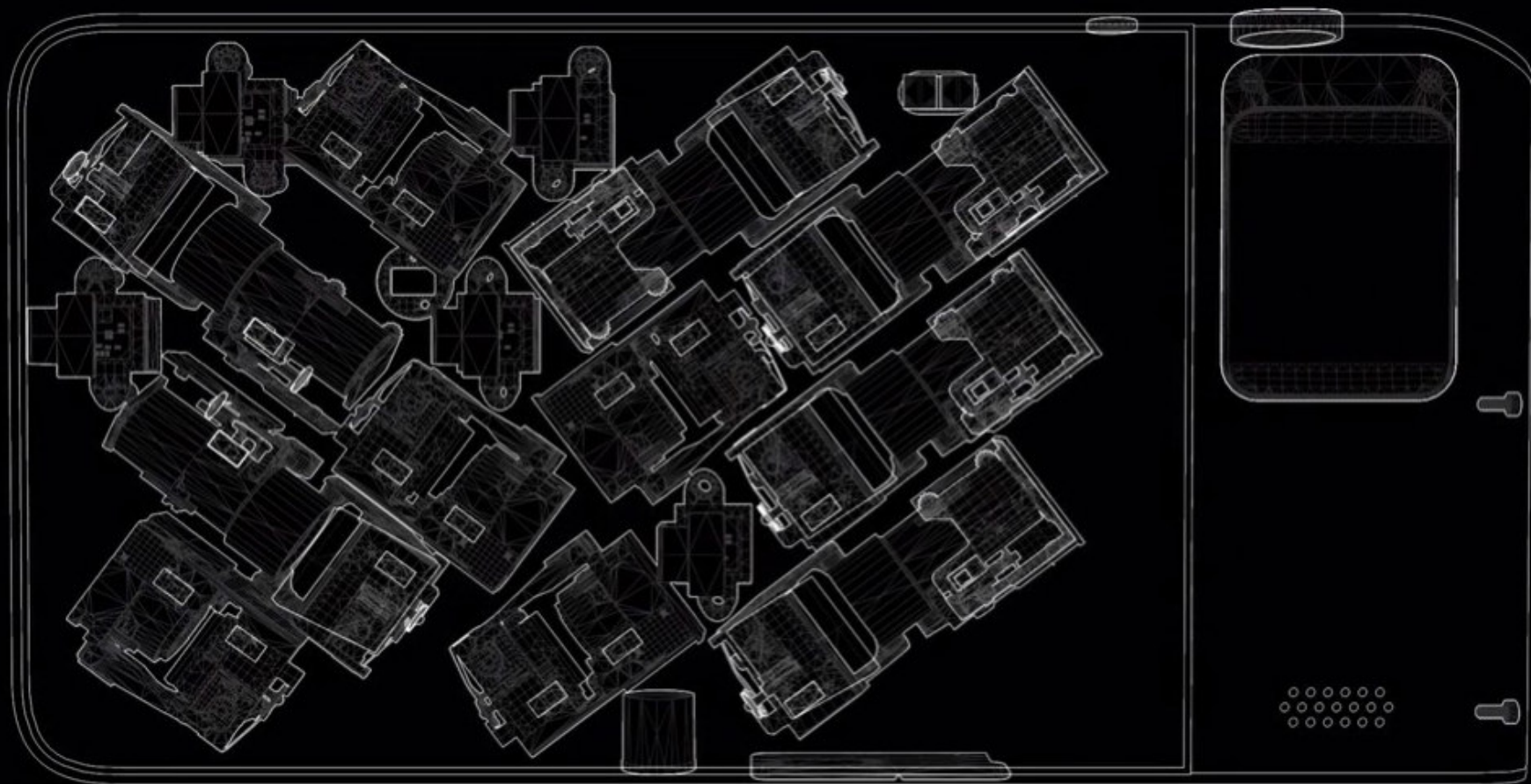
Röntgenbild der LIGHT F16 Kamera mit den 16 verschiedenen Objektiven
