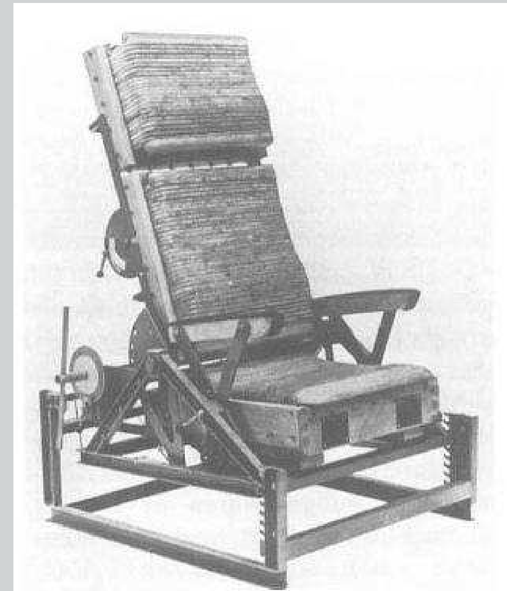
Sitzmaschine zur Untersuchung des Sitzkomforts in Abhängigkeit des Sesselprofils (nach Grandjean/Burandt)
